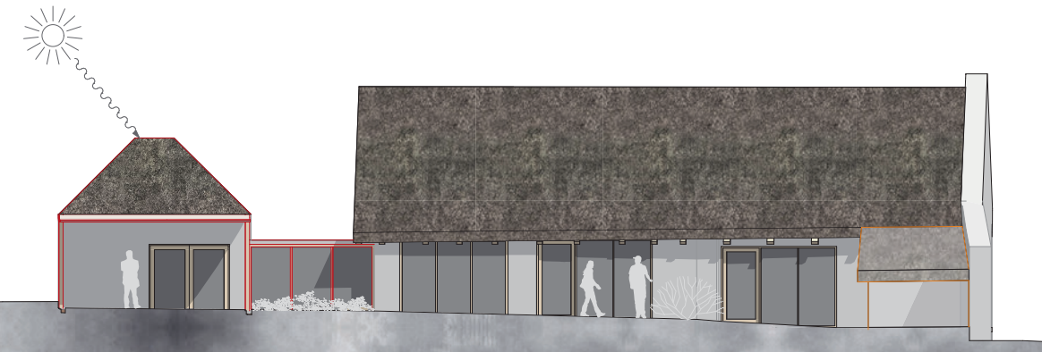
Fekete: megmaradó szerkezet Piros: új szerkezet Sárga: bontandó szerkezet
